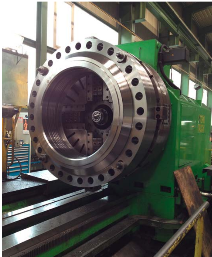
Fertigbearbeitung Dichtnuten Zylinderflansch
