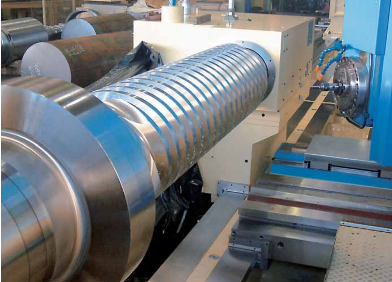
Fräsen einer Gewindespindel Ø 720 x 4.000 mm für Spindelpresse Milling of threaded spindle Ø 720 x 4,000 mm for screw press
