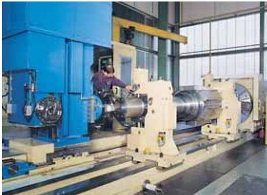
6-poliger Motorläufer, 16 t Komplettbearbeitung auf einem Bearbeitungszentrum
